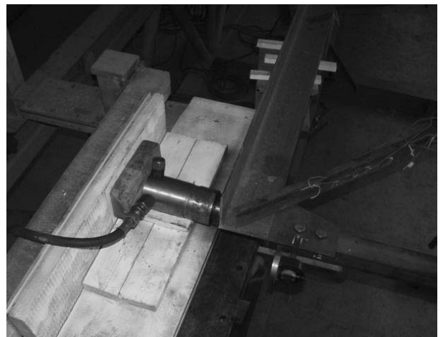
Рис. 11. Узел установки гидравлического домкрата ДГ-10
